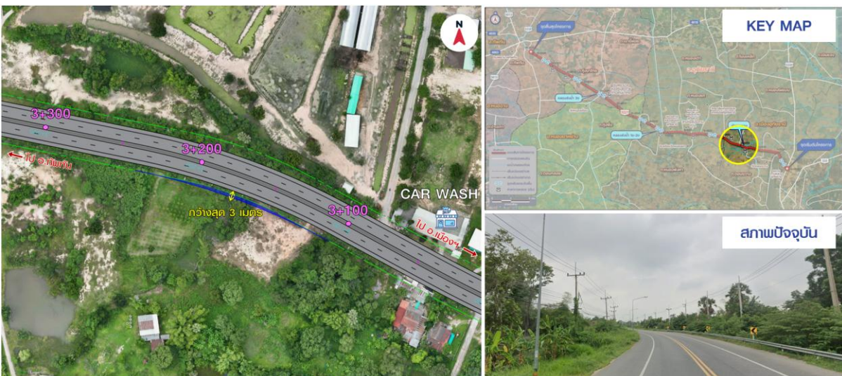
รูปที่ 6-9 ปรับปรุงแนวทางราบ กม.3+160
